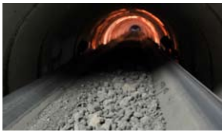
Transport de clinker dans une station de broyage
