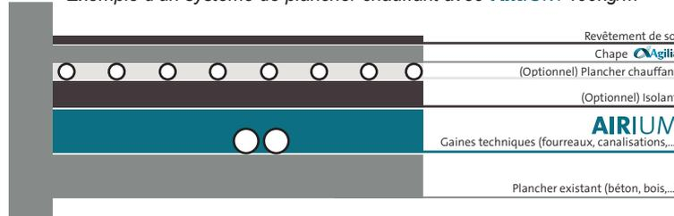
Exemple d'un système de plancher avec **AIRIUM 180kg/m<sup>3</sup>**
