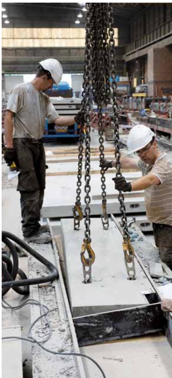
Chronolia Préfa est un béton prêt à l'emploi autoplaçant à durcissement rapide. Il est destiné au coulage d'éléments préfabriqués pour un décoffrage et/ou un levage très accéléré. Chronolia Préfa est un béton de la gamme Chronolia de Lafarge Bétons.
