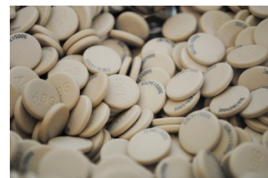
Puces RFID pour la traçabilité du béton
